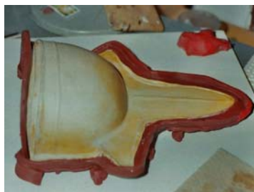
Abb. 23: Überarbeiteter Gipsausguss, fertig zum Abformen.
