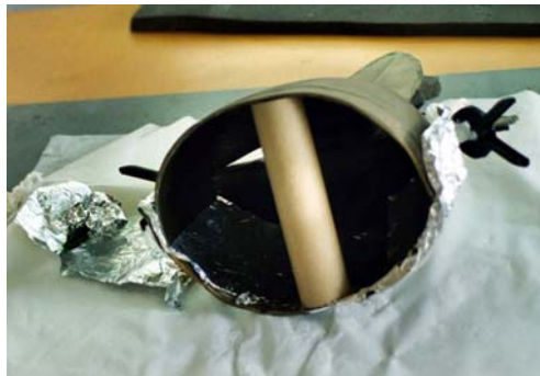
Abb. 28: Anpassung der beiden Helmhälften mit Isolierung gegen Hitze.
