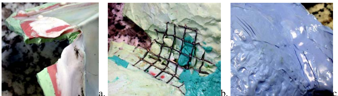
Abb. 15: a. Trennende Entspannungsschnitte – b. Unterbauungen im Detail vom Außenbereich der Silikonhaut. – c. Wenig tiefe Entspannungsschnitte im Außenhautbereich.
