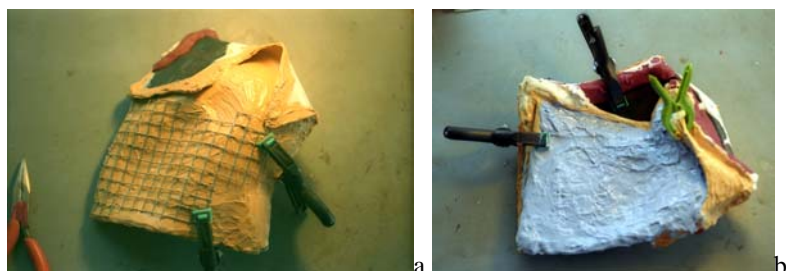
Abb. 10: a. Anpassen der Drahteinlage über der zweiten Silikonschicht – b. Dritte Silikonschicht über Drahtarmierung
