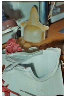
Abb. 25: Umgedrehte Form mit Gipsrohling im Hintergrund.
