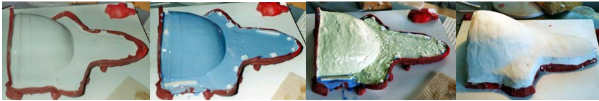
Abb. 24: Schichtabfolge der Abformung von 1. Silikonschicht bis Gipsstützkapsel.
