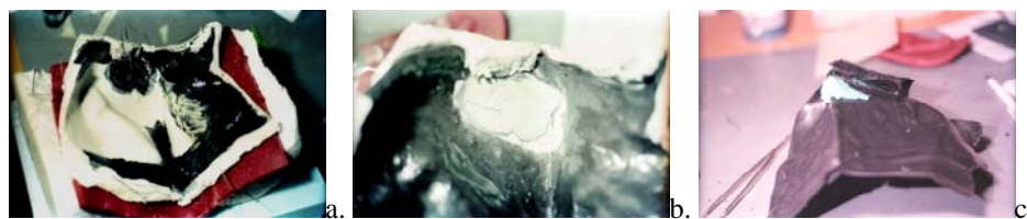
Abb. 7: a. Formhaut auf Bock bei Ausformarbeiten. – b. Detail Wachspapier im Bereich der Fehlstelle. – c. Detail des Wachspapiers am Ausguss nach dem Entformen und ersten thermoplastischen Rückformversuchen.
