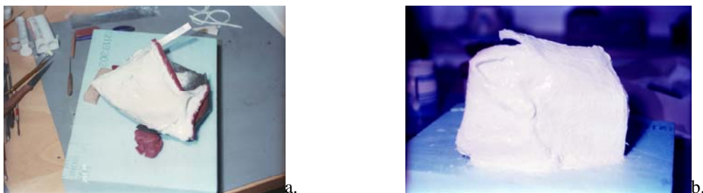
Abb. 6: a. Erste Silikonschicht bei liegendem Auftrag. - b. Zweite und dritte Silikonschicht bei stehendem Auftrag.
