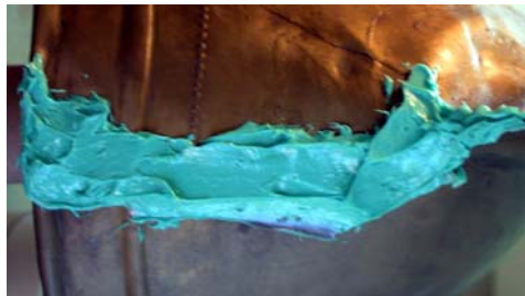
Abb. 29: Dentsilikonmanschette im Bereich der Überlappung.
