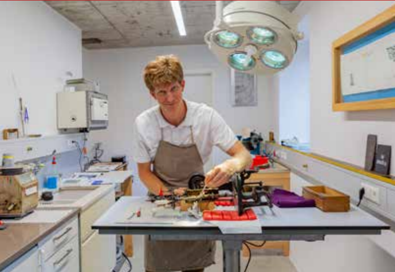
Laborraum: Aus Teilen eines Zahnarztstuhls und eines Behandlungstisches baute sich Nowak den auf- und abfahrenden Arbeitstisch für sein Labor.
